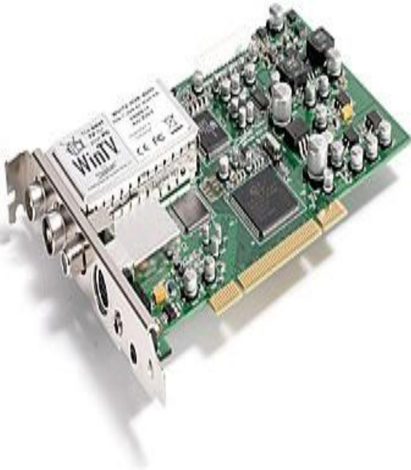
Es una tarjeta para expansión de capacidades que sirve para sintonizar las estaciones de radio de la frecuencia FM y las emisoras televisivas libres y de paga, así como capturar y guardar en formatos de audio y video específicos en el disco duro de la computadora.
