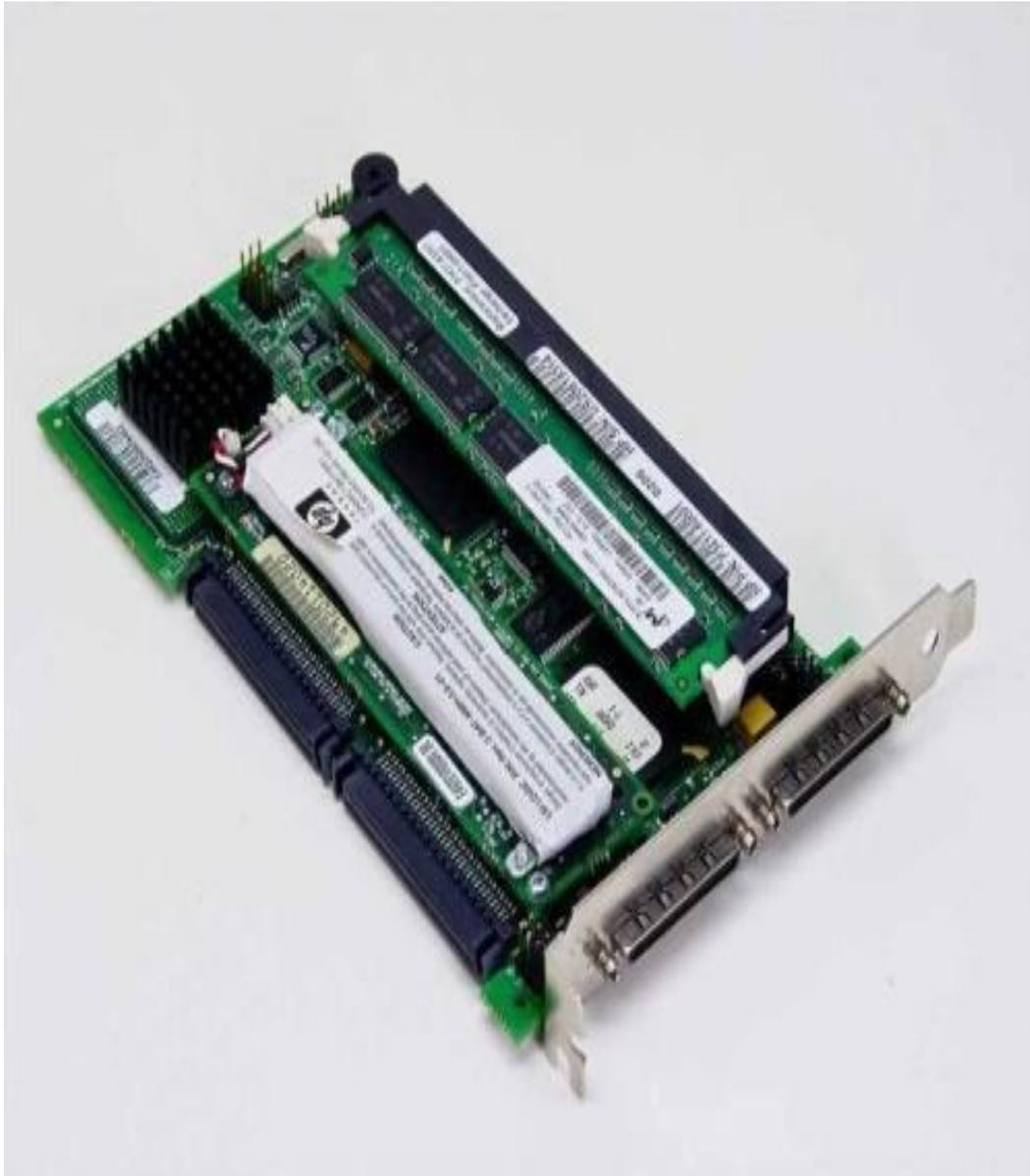
Es una tarjeta para expansión de capacidades que permite la conexión de varios tipos de dispositivos internos SCSI ("*Small Computer System Interface*"), esto es principalmente discos duros y puertos. . Este tipo de tarjetas integran uno o varios puertos para conectar los dispositivos externos tales como unidades lectoras de CD-ROM, escáneres y algunos tipos de impresoras entre otros.
