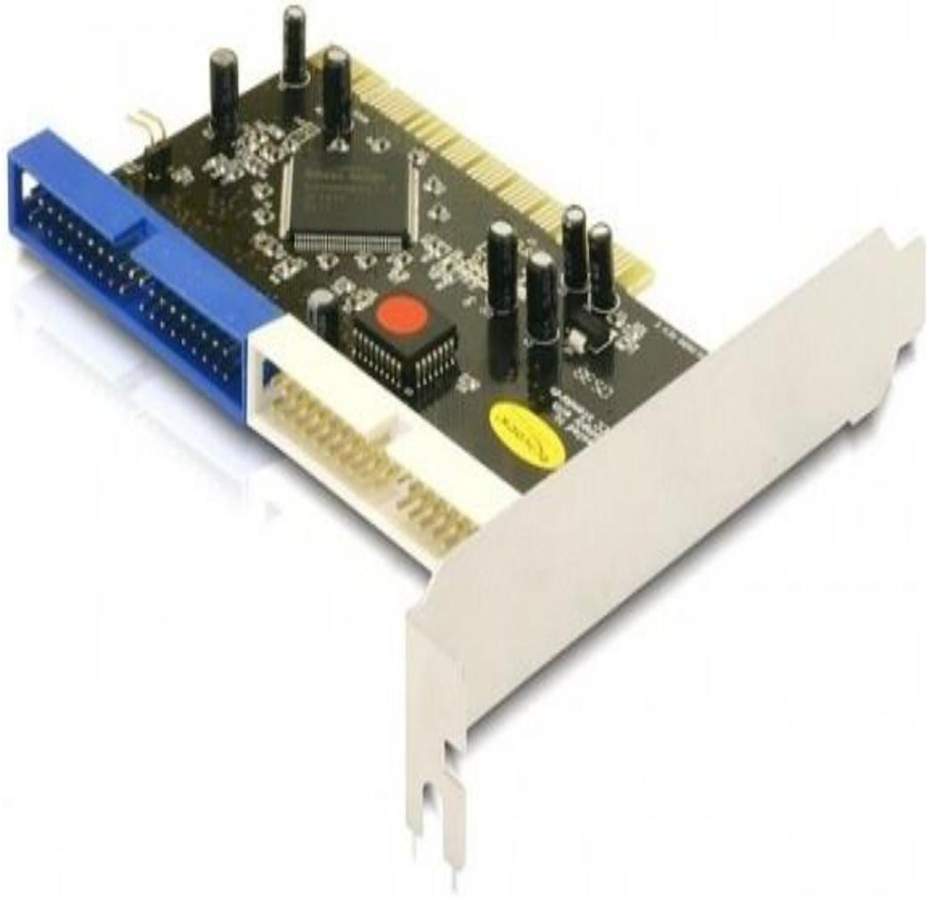
Es una tarjeta para expansión que permite la conexión de varios tipos de dispositivos internos IDE (*"Integrated Device Electronic"*), discos duros y unidades ópticas, así como disqueteras y ciertos puertos. Este tipo de tarjetas integran uno o varios puertos para conectar los dispositivos externos tales como el ratón, la impresora, el escáner, etc.
