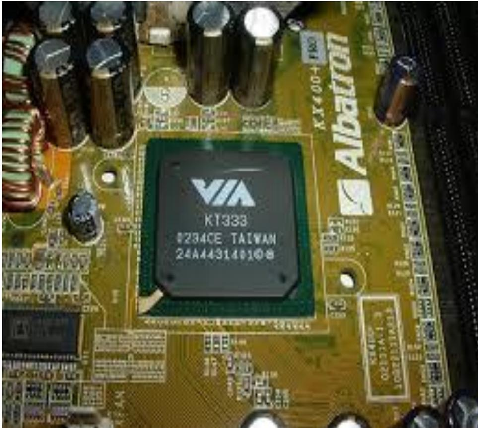
Es un circuito electrónico cuya función consiste en coordinar la transferencia de datos entre los distintos componentes del ordenador (incluso el procesador y la memoria).
