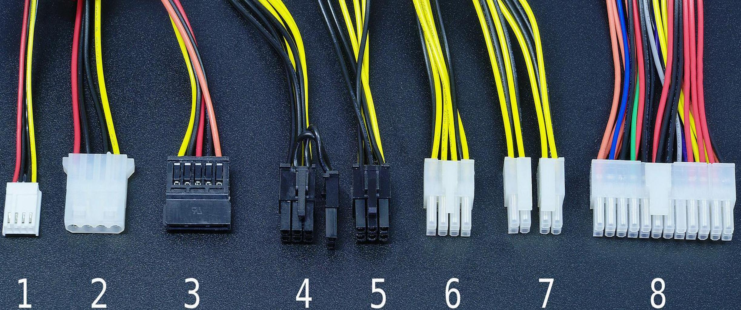
**Conectores de la fuente de alimentación ATX2 para PC: (1) mini molex para FDD. (2) Molex universal: para dispositivos IDE, HDD y unidad de disco óptico. (3) para dispositivos SATA. (4) para tarjetas gráficas de 8 pines, separable para 6 pines. (5) para tarjeta gráfica de 6 pines. (6) para placa base de 8 pines. (7) para CPU P4, combinado para el conector de la placa base de 8 pines a 12V. (8) ATX2 de 24 pines.**
