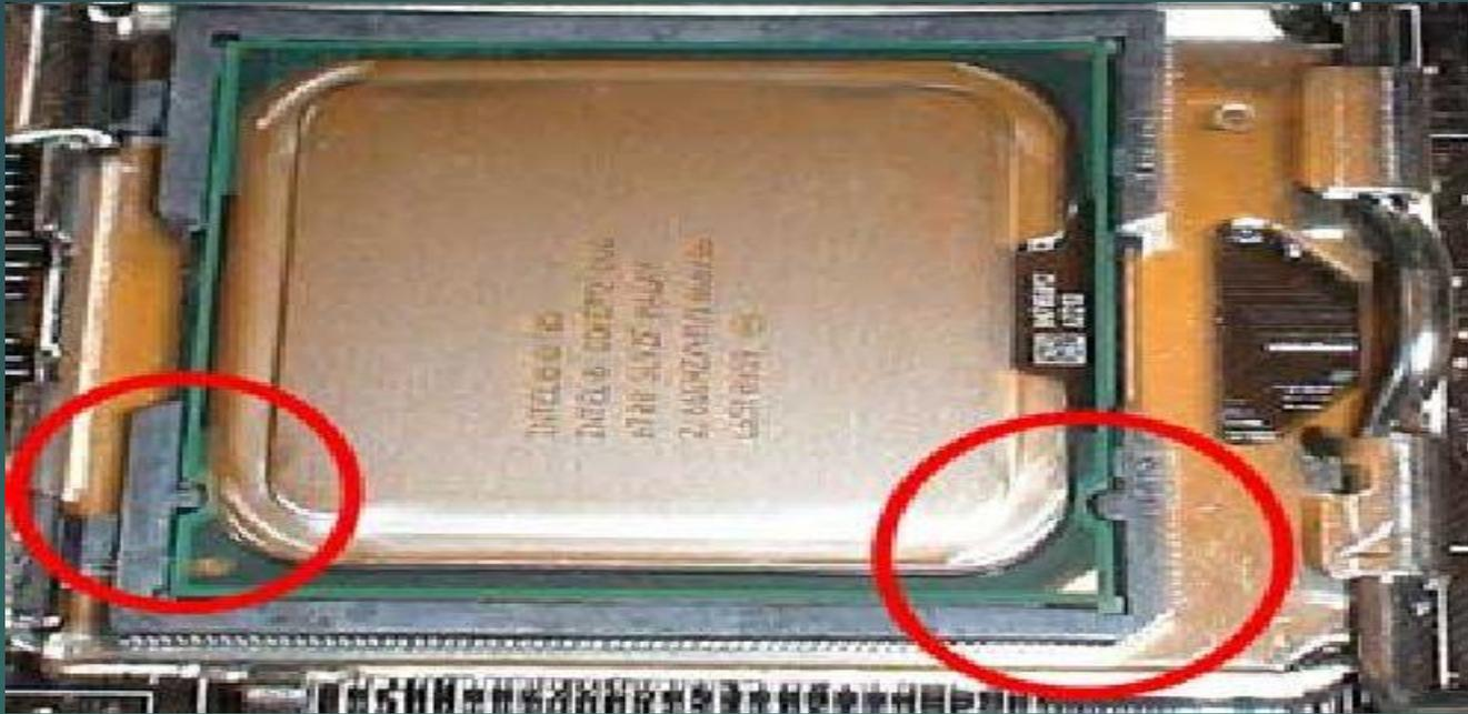
**Colocamos con cuidado el procesador sobre el zócalo, y sin ejercer mucha presión insertamos los pines del procesador en las ranuras del zócalo. Para ello no debemos hacer fuerza, sólo dejar que el CPU se integre al zócalo. En el caso de que esto no suceda, posiblemente se deba a que el procesador posee alguno de sus pines doblados, el cual podremos enderezar con mucho cuidado con la ayuda de un destornillador plano.**
